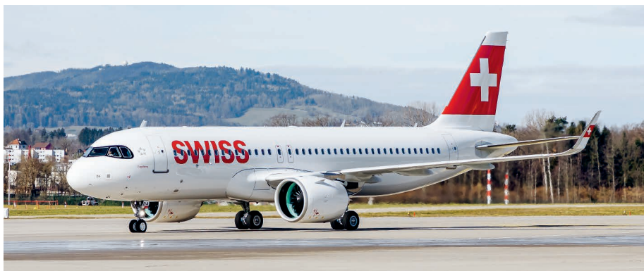
Der neue A320neo von SWISS verbraucht bis zu 20% weniger Treibstoff und hat einen um 50% kleineren Lärmteppich als vergleichbare Flugzeugtypen.
